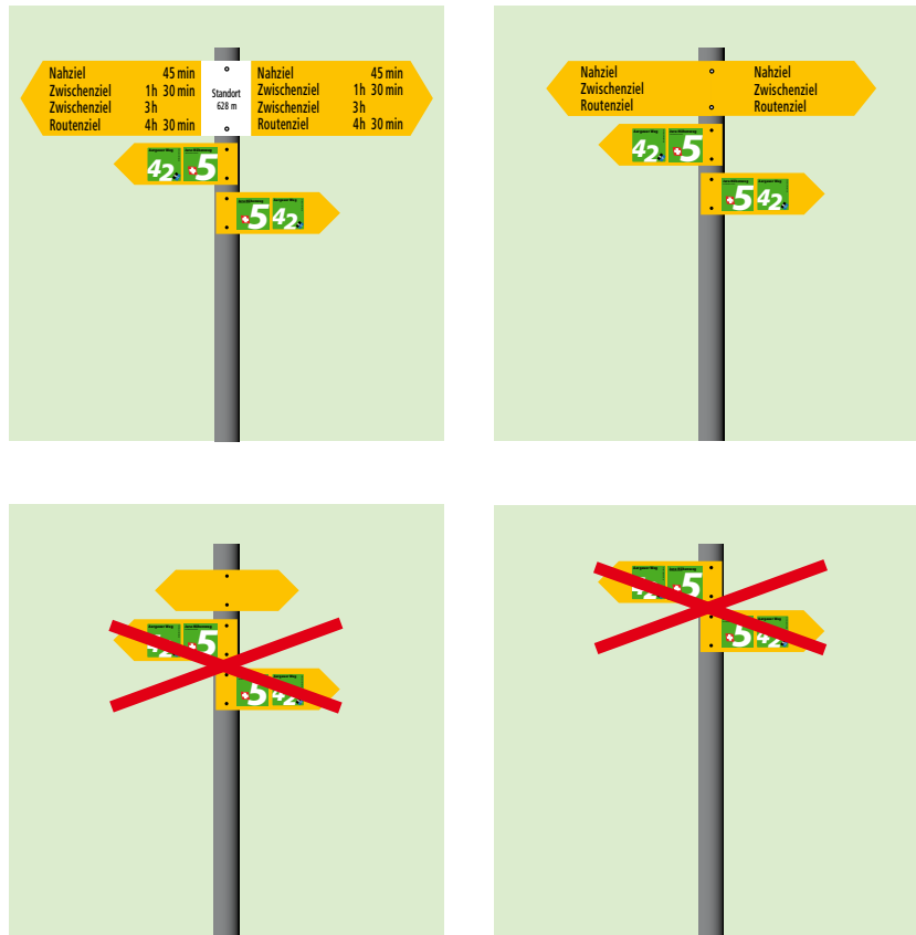
Abb. 18 Montagehinweise für Wegweiser mit Routenfeldern.
